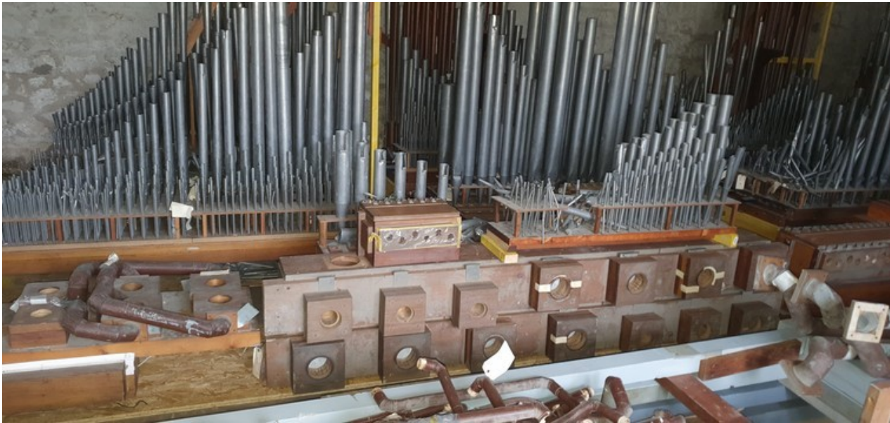
Suite du Cornet GO (côté C) et des moteurs du 32 pieds de pédale. En arrière plan, la tuyauterie du GO à droite et du Récit à gauche.
